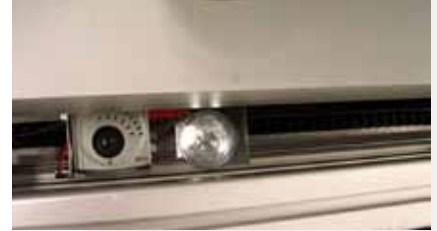
2つのカメラでトンボを読み取り、正確な断裁位置合わせを実現します。
