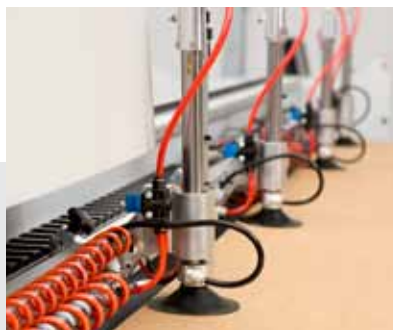
吸引式グリッパは、シートを振り落として斜めにすることで資材を分離させます。
