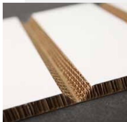
サンドウィッチボードのVノッチ加工
